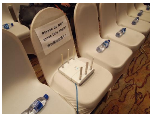
圖七:本次會議 AP 的擺放情形為直接置於椅子上-而不用 STAND 支架或置於地上的方式
